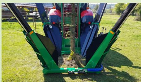
Угол наклона лопат предотвращает повреждения деревьев даже с низко-расположенными ветвями нижнего яруса
