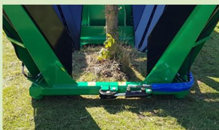
Гидрофицированный замок запирает раму, гарантируя безопасную работу как для оборудования, так и для посадочного материала
